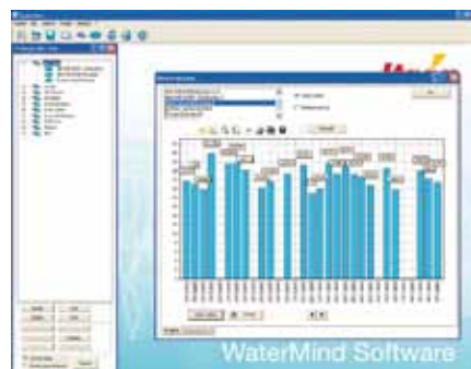
Gruppenfunktionen, mit denen der Wasserverbrauch nach Kundenkategorien, Versorgungsbereichen usw. zusammengefasst oder verglichen werden kann.
